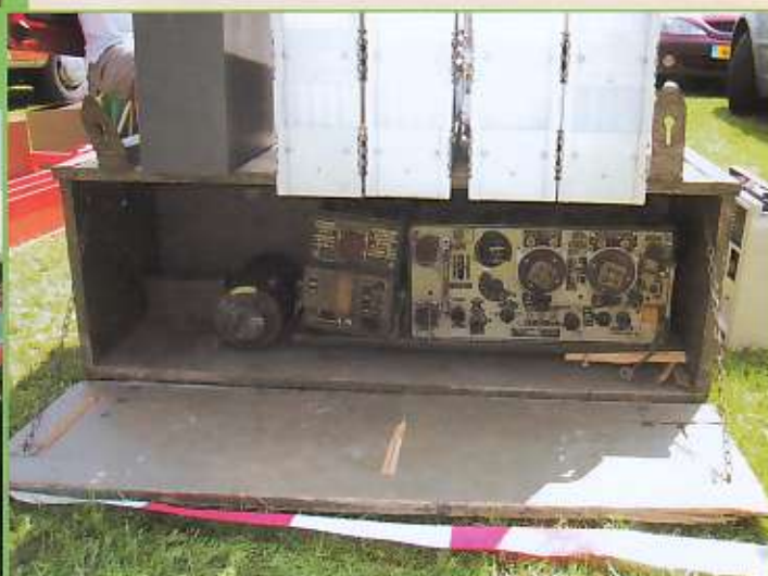
Hij lijkt niet helemaal gaaf, deze 19-set, uit de Tweede Wereldoorlog, de meter zit een beetje scheef. Het is een uitvoering met teksten in het Engels en het Russisch.
