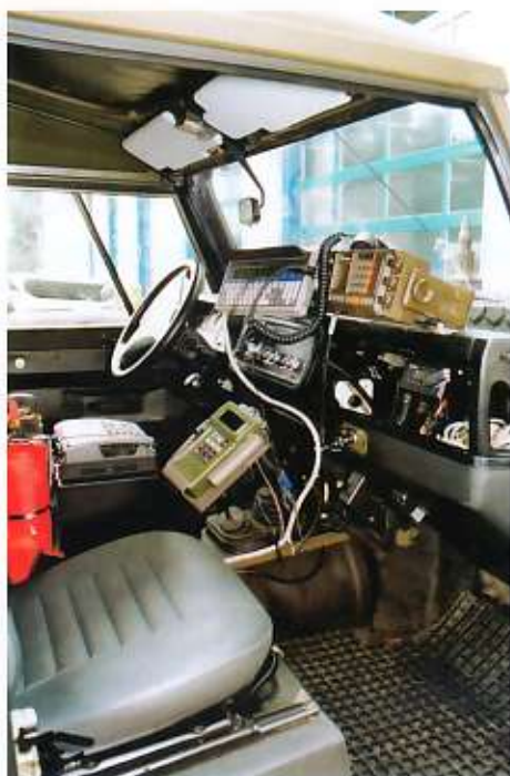
Het digitale tijdperk heeft ook bij de zeesoldaten haar intrede gedaan. Ingebouwd zijn een GPS (jel-groen) met voertuigvoeding en voertuigantenne. De grijze 'telefoon' is een satelliettelefoon Mini M. Het grijze toetsenbord is een Inmarsat C mobile voor het versturen van data en de andere groene radio is de Motorola Micon HF-apparatuur.
